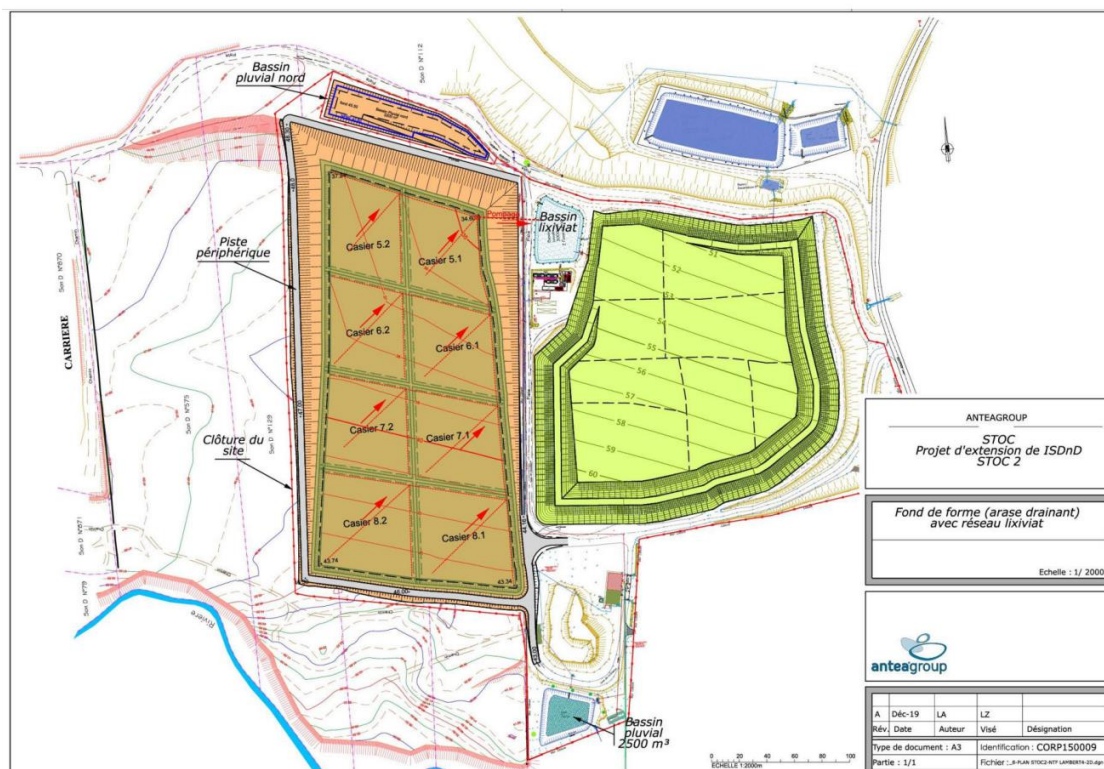
Figure 7 : Plan de masse de l'ISDnD STOC 2 de Prunelli-di-Fium'Orbu et de son projet d'extension
